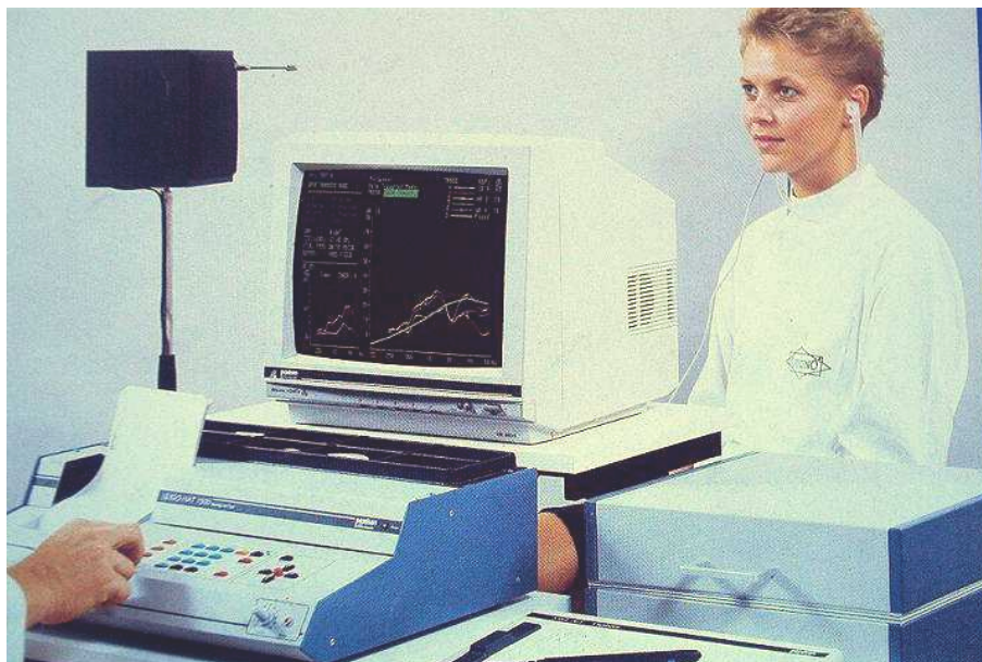
Рис. 2.3. Система для измерения реального усиления «IGO – NAT 1500».
